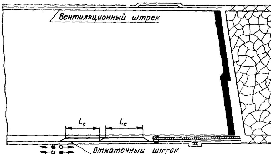
Рис. 2.11 Технологическая схема участкового транспорта при столбовой системе разработки
