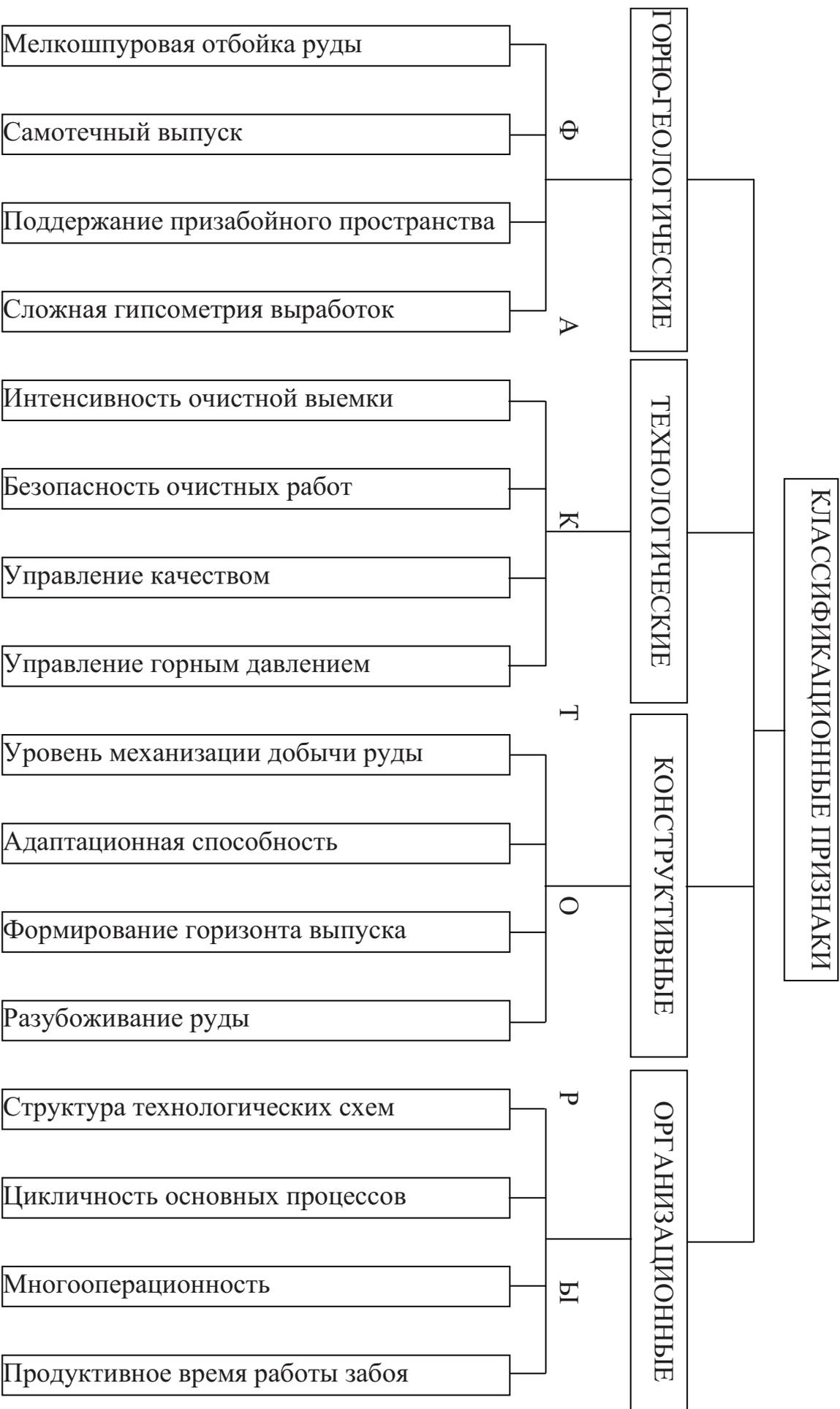
Рис. 2.1. Факторы, определяющие специфику очистных работ на тонкожилых крутопадающих месторождениях
