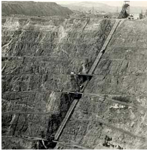
Рис. 7.4. Похилий скіповий підйомник на Сибайському міднорудному кар'єрі (РФ)
