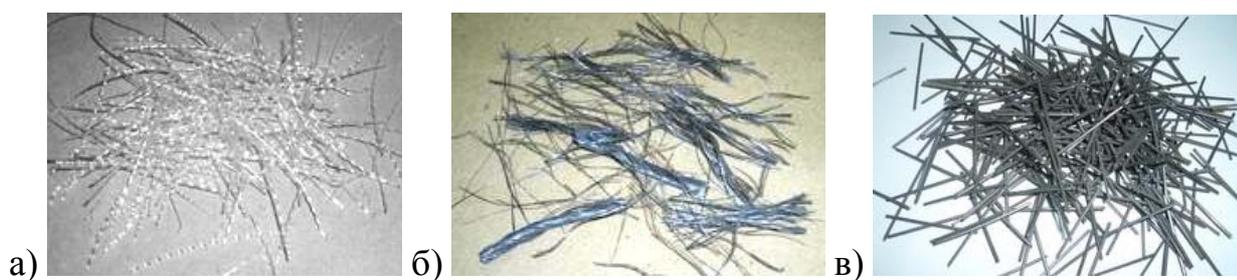
Рис. 2. Волокна, используемые для приготовления фибробетона: а – извилистые полимерные волокна, б – жесткие полимерные волокна, в – металлические волокна.
